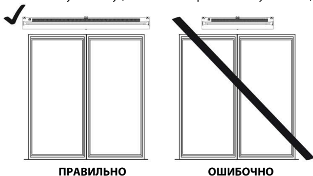
РИС. 7.1 ПРАВИЛЬНАЯ ГОРИЗОНТАЛЬНАЯ УСТАНОВКА.
