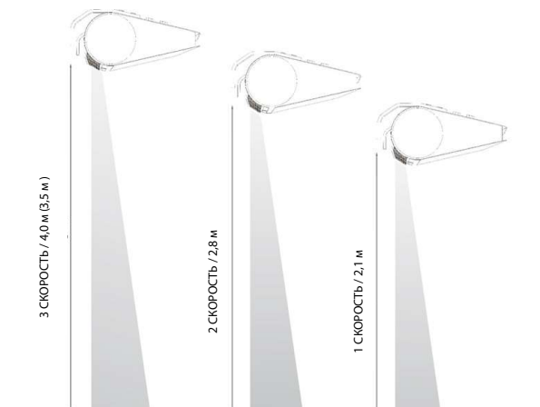
РИС. 2.2 ДЛИНА ПОТОКА ВОЗДУХА НА КАЖДОЙ СКОРОСТИ.
