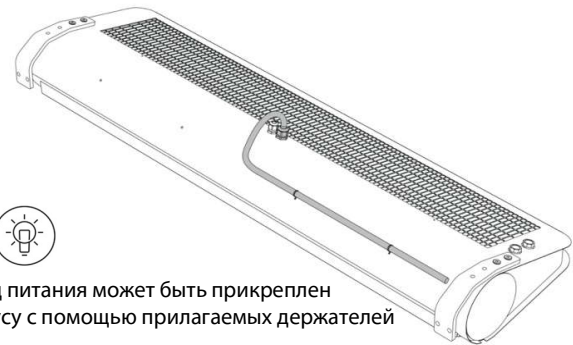
РИС. 11.6 ПРОКЛАДКА КАБЕЛЯ ВОКРУГ КОРПУСА
